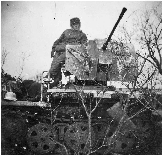
*Ein deutscher Soldat posiert neben einer 20-mm-Flak 38, die auf einem SdKfz 10/4-Halbkettenfahrzeug montiert ist, während einer Pause zwischen den Verteidigungskämpfen in Ostpreußen. Auf dem Schild des Geschützes sind einige Nebelhandgranaten 39 zur Verteidigung der Besatzung montiert.*
